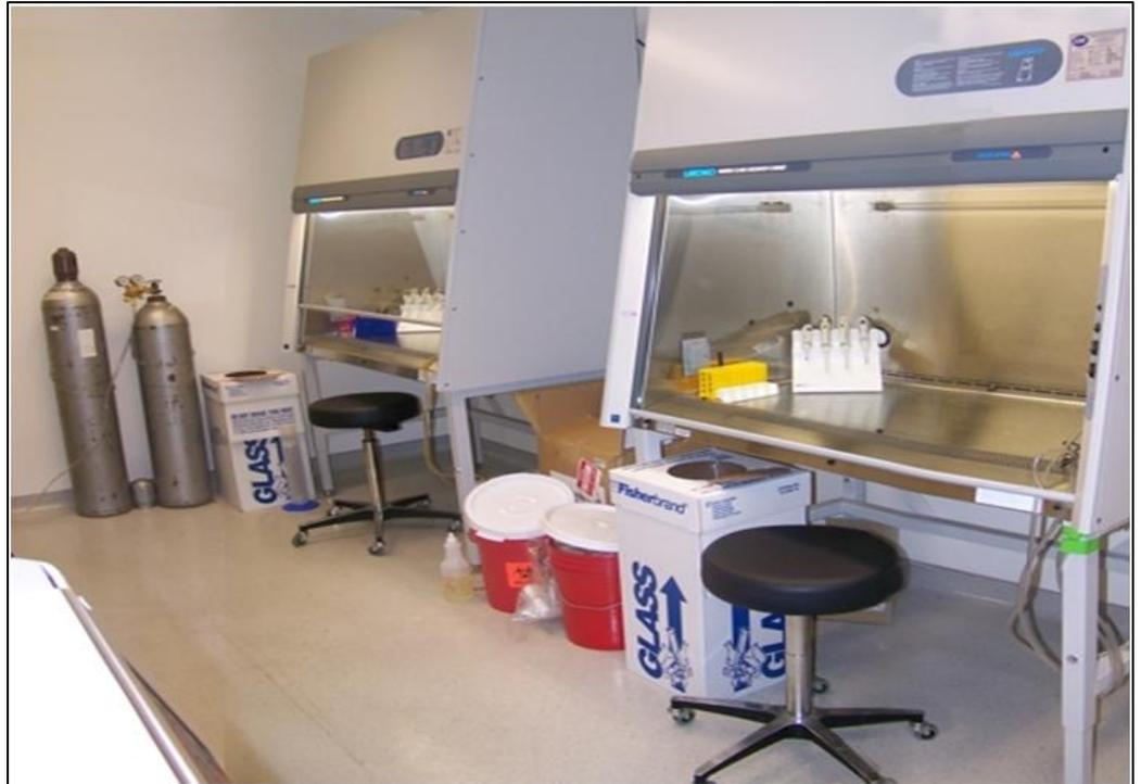
Im Fall der oben gezeigten schematischen Haube durchtritt Luft erst einen **HEPA Filter** (High Efficiency Particulate Air). Gefilterte, sterile Luft strömt dann von oben nach unten und verlässt die Haube durch die Öffnung. Das genaue Design ist variable und ist vom Hersteller abhängig.
